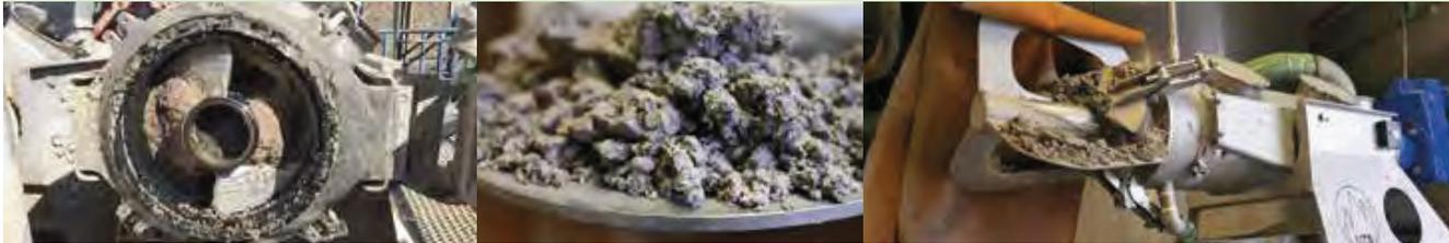
Der UTS Separator ist eine High-End Filterschneckenpresse zum effektiven Separieren von faserhaltigen Suspensionen und Schlämmen, wie z.B. Gülle, Gärsubstrate, Schlempe, Schlachtabfälle, Rejekte und Abwasser aus Papier- und Holzverarbeitender Industrie sowie Abfällen aus der Lebensmittelindustrie.
